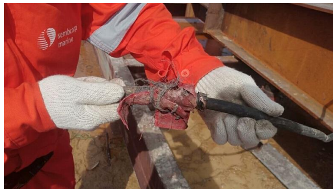
Gambar 2. 18 penyambungan pada kabel las yang putus.
