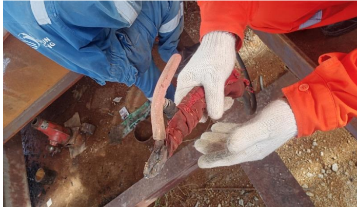
Gambar 2. 19 stang las yang rusak.
