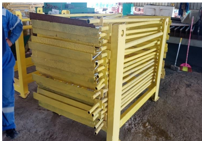
Gambar 2. 30 penyusunan cable hanger dalam rak
