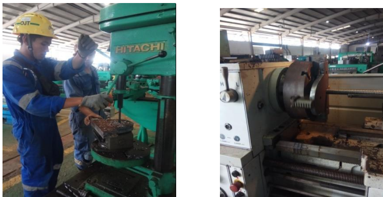
Gambar 2. 48 proses pengeboran pada plat 20mm menggunakan mesin bubut dan mesin bor
