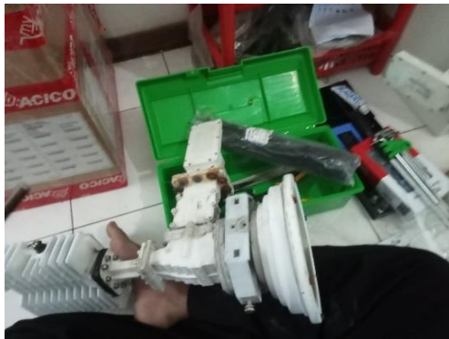
Gambar 3.21. Melepaskan Setiap Bagian dari FeedHorn Prodelin
