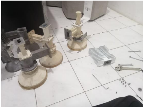
Gambar 3.23. FeedHorn Prodelin yang sudah Tanpa Bagian Tambahan
