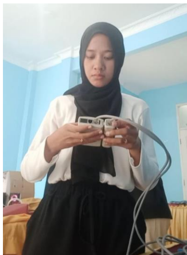
Gambar 3. 9 Membuat Kabel Jaringan dan Melakukan Tester Kabel
