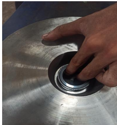
Gambar 4. 17 Pemasangan Mechanical Seal Rotary (Sumber: dokumen pribadi)
