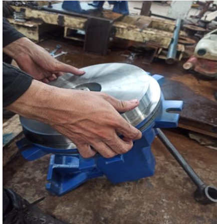
Gambar 4. 19 Pemasangan Seal Plate (Sumber: dokumen pribadi)
