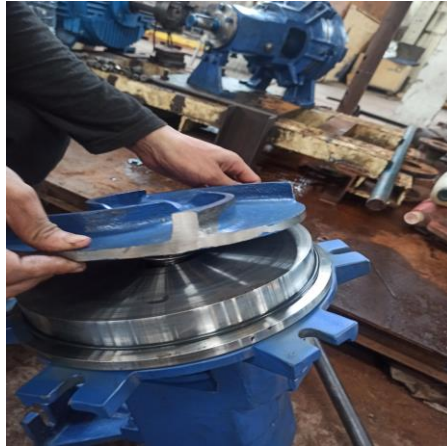
Gambar 4.22 Proses Pemasangan Impler
