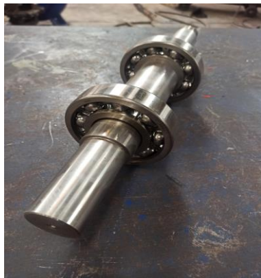
Gambar 4. 15 Bearing Yang Sudah Dipasangkan Ke Drive Shaft Pompa (Sumber: dokumen pribadi)
