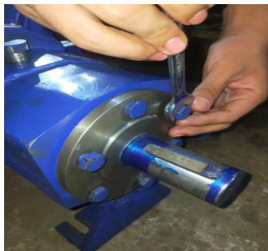
Gambar 4. 18 Pemasangan Bearing Cover (Sumber: dokumen pribadi)
