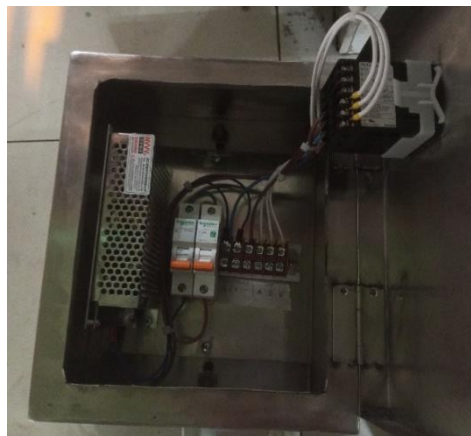
Gambar 3.6. Komponen yang telah dipasang kedalam frame (sumber : dokumentasi penulis 2023)
