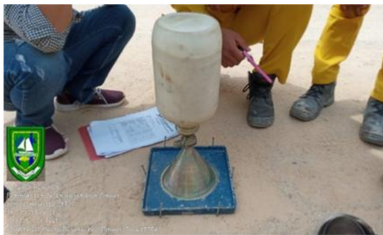
Gambar 3.6 Pengujian sand cone pada lapisan base B Sumber: Dokumentasi lapangan, 2023
