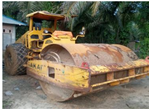
Gambar 4.4 Alat Berat Vibrator Roller Sumber: Dokumentasi lapangan, 2023
