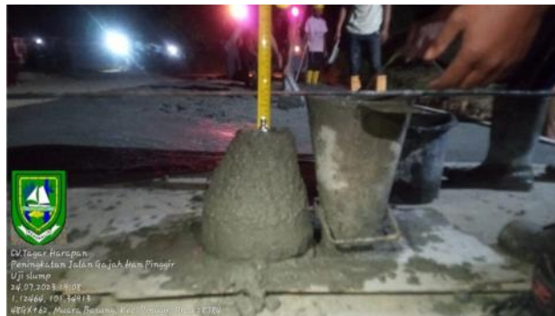
Gambar 3.10 Pengujian Uji Slump Beton LC Sumber: Dokumentasi lapangan, 2023
