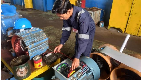
Gambar 3.10 Pengukuran Tahanan Dalam Menggunakan Megger.
