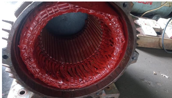
Gambar 3.11 Pengelakan Pada Kumparan Stator.
