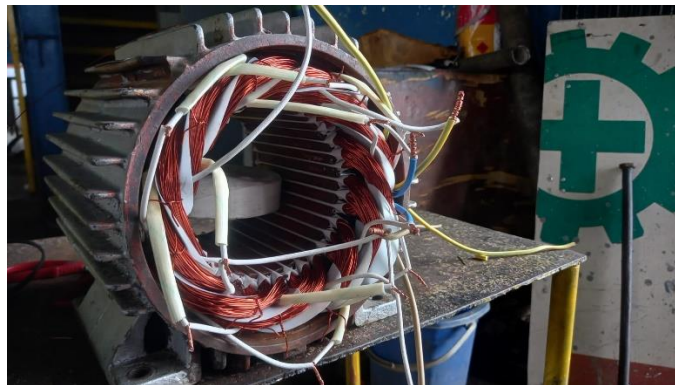
Gambar 3.9 Menyambungkan Gulungan Dengan Line .
