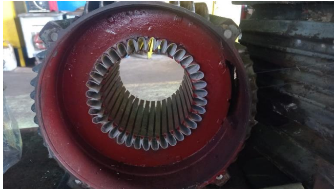
Gambar 3.6 Pemasangan Isolator/Prespan pada Slot Stator.
