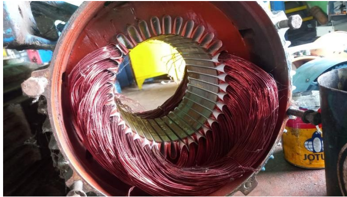
Gambar 3.8 Memasukkan Gulungan Pada Slot Stator.
