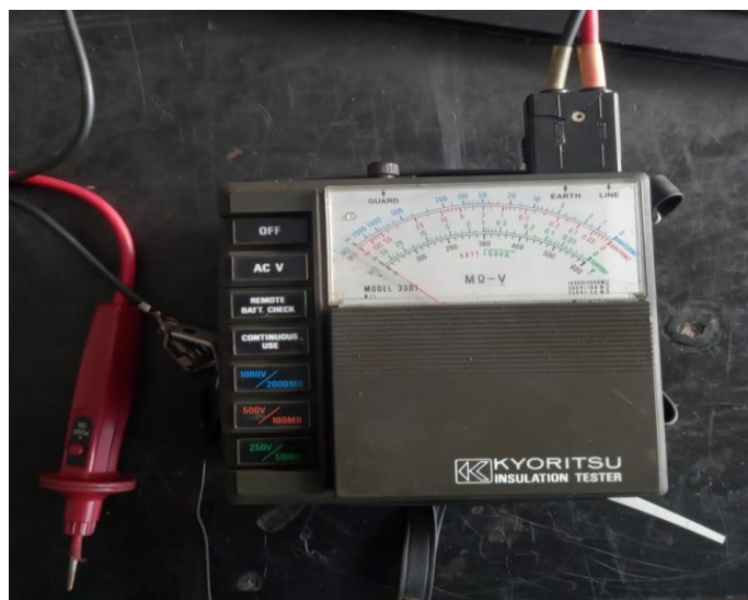
Gambar 3.4 Alat Pengukuran Tahanan Dalam Motor
