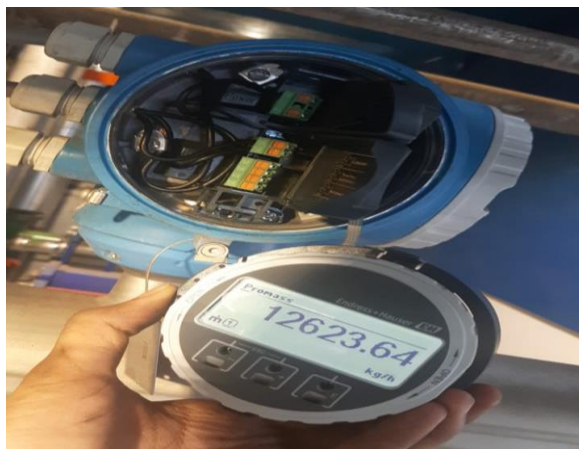
Gambar 2.8 Mengganti Flowmeter Sumber : PT. Wilmar Nabati Indonesia Dumai-Pelintung, (2022)
