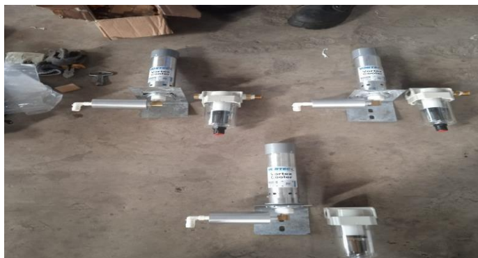
Gambar 2. 31 Pembuatan Dudukan Culler (Sumber: Dokumentasi di PT. Indah Kiat Pulp and Paper)
