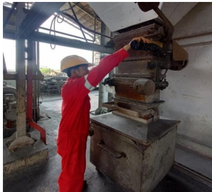
Gambar 3. 3 Preventive Maintenance pada bearing dust collector (Sumber : Dokumentasi Penulis)
