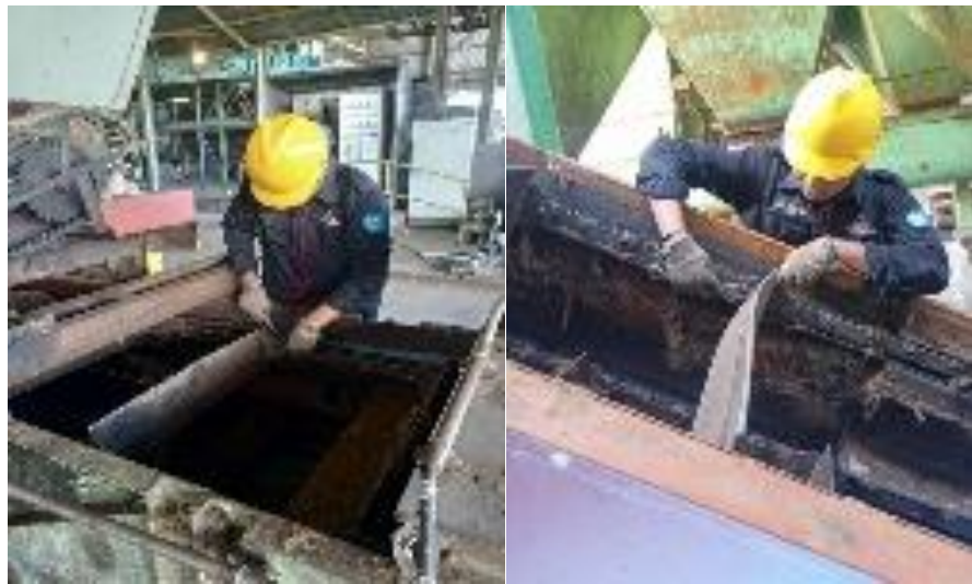
Gambar 4. 15 Melepas scraper conveyor yang rusak
