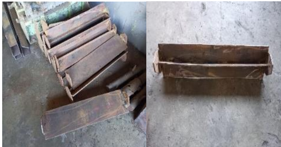
Gambar 4. 14 Scraper conveyor tampak dari depan & belakang
