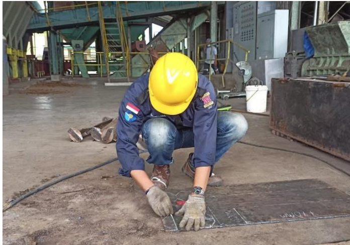
Gambar 4. 7 Membuat pola scraper conveyor
