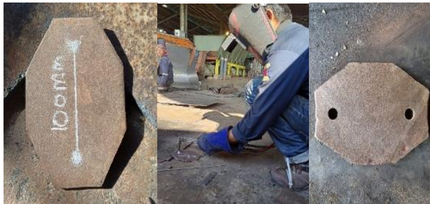
Gambar 4. 12 Pengukuran, melobangin, sudah dilobangin
