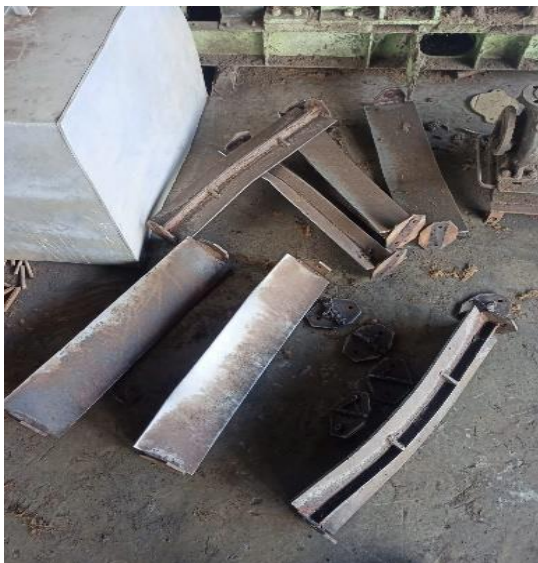
Gambar 4. 17 Scraper conveyor yang rusak
