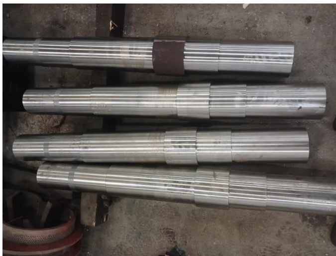
Gambar 4.7 Benda kerja yang telah selesai proses pemakanan 75% (Sumber: dokumen pribadi)
