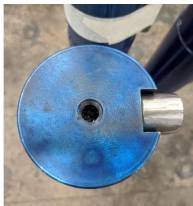
Gambar 4.12 Benda kerja yang sudah selesai dicat dan dipasang bos spi (Sumber: dokumen pribadi)
