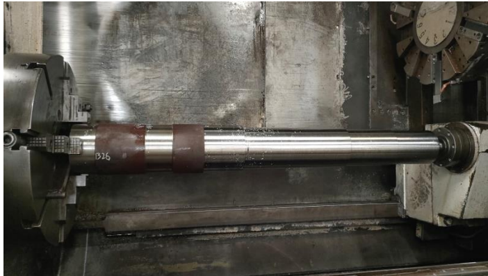
Gambar 4.6 Benda kerja yang telah selesai proses pemakanan 50% (Sumber: dokumen pribadi)
