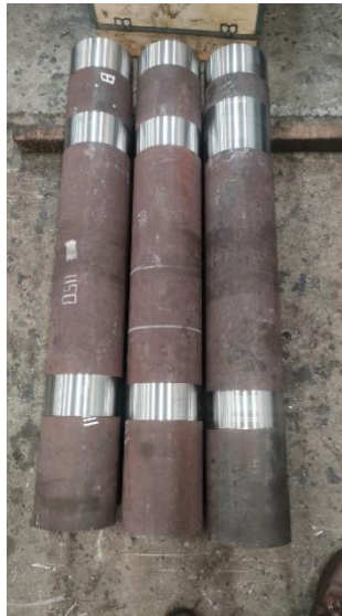
Gambar 4.3 Benda kerja yang telah selesai di lakukan center (Sumber: dokumen pribadi)
