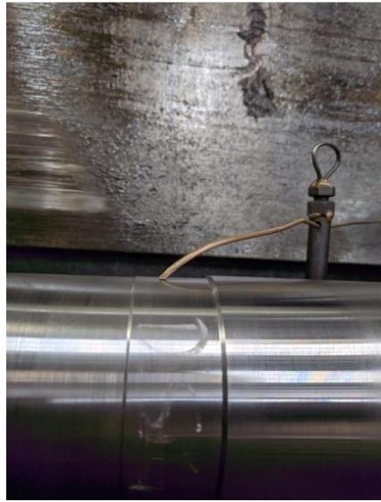
Gambar 4.4 Benda kerja di setting center terlebih dahulu (Sumber: dokumen pribadi)
