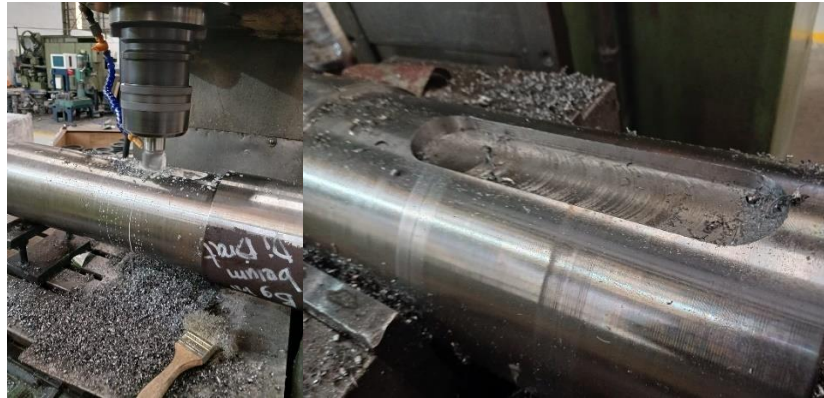
Gambar 4.11 Pembuatan lubang spi (Sumber: dokumen pribadi)
