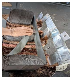
Gambar 2.5 Pemasangan Core Trafo (Sumber : Dokumentasi 2023)
