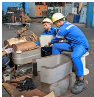
Gambar 4.8 Pemasangan Inti Besi (Sumber : Dokumentasi 2023)
