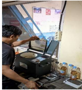
Gambar 2.31 Pengujian Tegangan Tembus Minyak Trafo (Sumber : Dokumentasi 2023)
