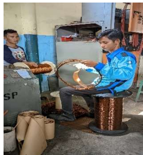
Gambar 2.17 Penggulangan Kawat Bekas yang Masih Bisa Digunakan (Sumber : Dokumentasi 2023)
