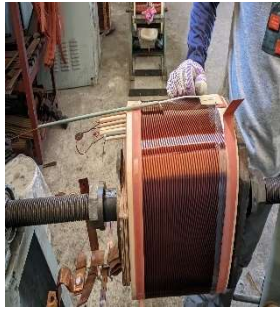
Gambar 2.41 Pemasangan Selongsong Kawat dan Kertas Lapisan (Sumber : Dokumentasi 2023)
