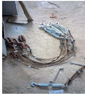
Gambar 2.60 Isolator TUI yang Terhubung dengan Span Sekrup (Sumber : Dokumentasi 2023)
