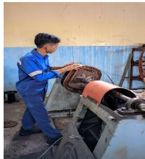
Gambar 2.26 Penggulangan Kumparan (Sumber : Dokumentasi 2023)
