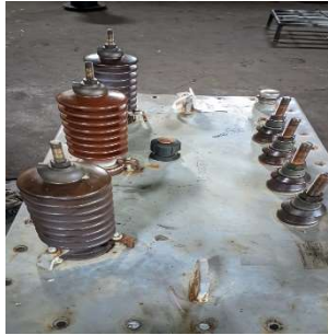
Gambar 3.4 Bushing Trafo (Sumber : Dokumentasi 2023)
