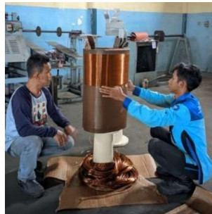
Gambar 4.6 Pembongkaran Kumaran (Sumber : Dokumentasi 2023)
