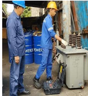
Gambar 2.43 Pengujian Tahanan Isolasi (Sumber : Dokumentasi 2023)
