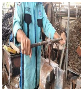
Gambar 2.55 Senai Ulang Baut dan Mur (Sumber : Dokumentasi 2023)
