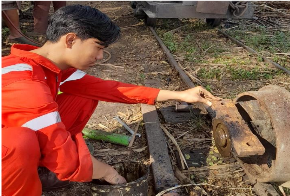
Gambar 2.4 Preventive Maintenance Pada Roda Lori
