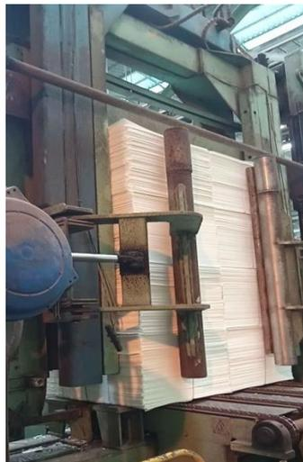
Gambar 3. 17 Gambar unit bale pulp dipress dan dirapikan
