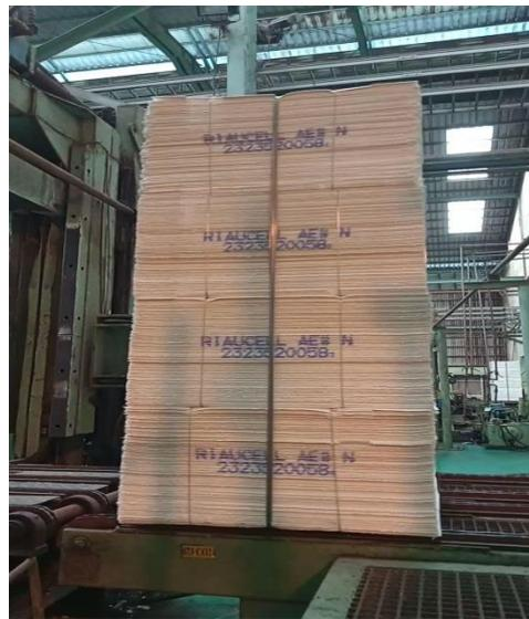
Gambar 3. 18 Gambar setelah unit bale pulp di ikat.
