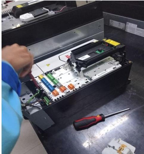
Gambar 2. 17 Gambar Pemasangan Kabel Motor
