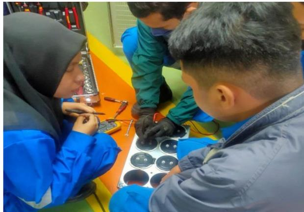
Gambar 2. 8 Gambar pengecekan Nilai kapasitor
