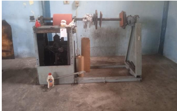
Gambar 4.1. Mesin Rewinding Trafo (sumber : Dokumentasi 2023)
