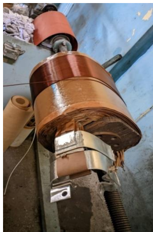
Gambar 3.5. Penggulangan Kumparan Primer
