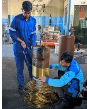
Gambar 3.1. Kumparan Terbakar (sumber : Dokumentasi 2023)
