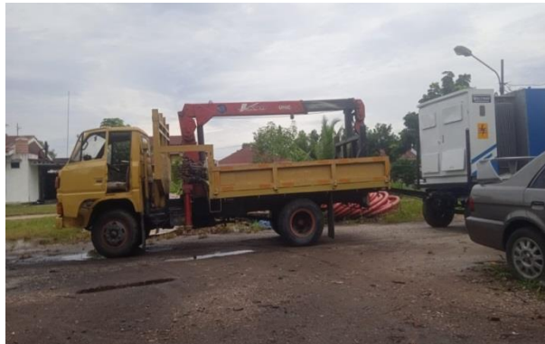
Gambar 2.33. Pengantaran Unit Gardu Bergerak(UGB)
