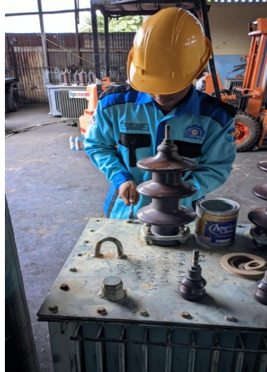
Gambar 2.5. Perakitan Trafo (sumber : Dokumentasi 2023)
