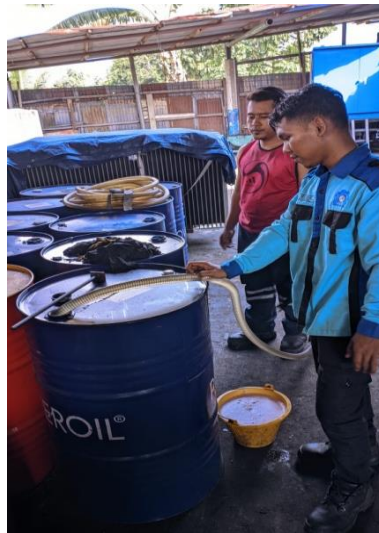
Gambar 2.13. Penyedotan Minyak (sumber : Dokumentasi 2023)
