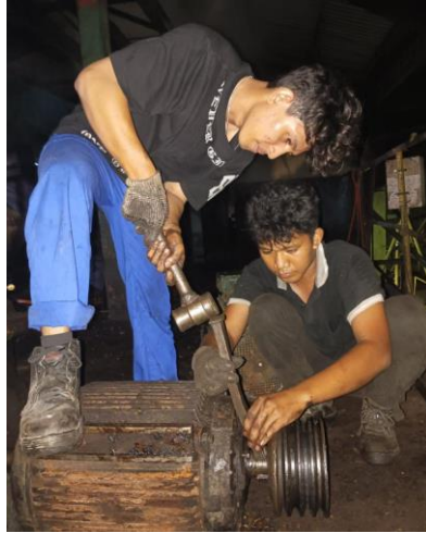
Gambar 2. 69 Mengganti elmot gester yang terbakar lilitan nya Sumber : Dokumentasi pribadi
