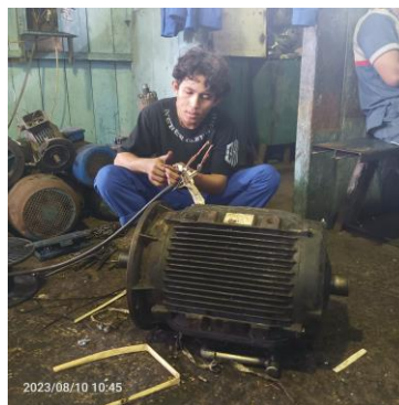
Gambar 2. 52 Mengcouple elmot 55 Kw Sumber : Dokumentasi pribadi
