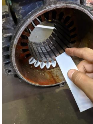
Gambar 2. 35 Memasang kertas prespan untuk elmot kondensat perebusan Sumber : Dokumentasi pribadi
