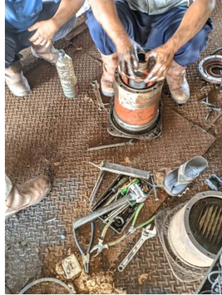
Gambar 2. 17 Mengganti kopling dan bearing stator crane Sumber : Dokumentasi pribadi
