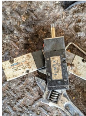
Gambar 2. 30 Mengganti solenoid inlet perebusan Sumber : Dokumentasi pribadi
