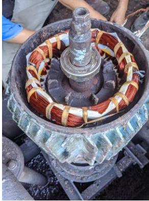
Gambar 2. 37 Merakit Kembali elmot kondensat untuk rebusan 7,5 Kw Sumber : Dokumentasi pribadi
