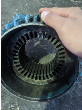
Gambar 2. 53 Membuat alas kertas prespan untuk elmot 5 Kw Sumber : Dokumentasi pribadi
