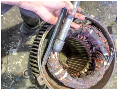
Gambar 2. 46 Membongkar elmot 37 Kw untuk waduk Sumber : Dokumentasi pribadi
