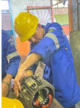
Gambar 2. 5 Merakit elmot konveyor Sumber : Dokumentasi pribadi
