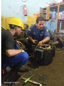
Gambar 2. 55 Mengcouple elmot sandfilter water pump Treatment Sumber : Dokumentasi pribadi
