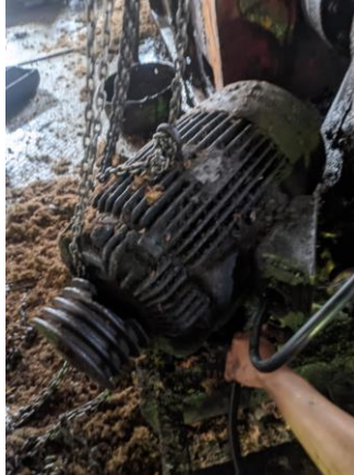
Gambar 2. 65 Memasang elmot pressan nomor 7 Sumber : Dokumentasi pribadi
