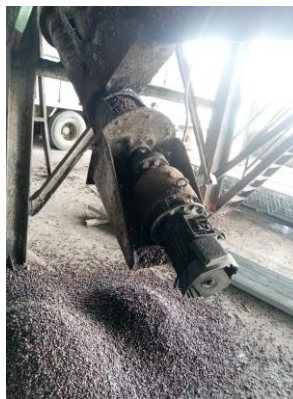
Gambar 2. 8 Elmot konveyor yang akan di ganti Sumber : Dokumentasi pribadi
