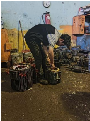
Gambar 2. 38 Memasang kertas prespan untuk elmot konveyor 5,5 Kw Sumber : Dokumentasi pribadi
