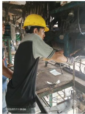
Gambar 2. 26 Mengganti elmot crane yang terbakar lilitan nya Sumber : Dokumentasi pribadi
