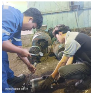
Gambar 2. 44 Mengganti elmot crane turun naik Sumber : Dokumentasi pribadi
