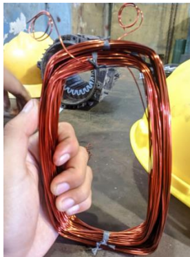
Gambar 2. 6 Melilit kawat email untuk elmot pompa Sumber : Dokumentasi pribadi
