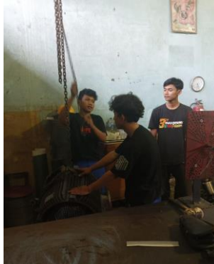
Gambar 2. 51 Memindahkan elmot raw water pump waduk 37 Kw Sumber : Dokumentasi pribadi
