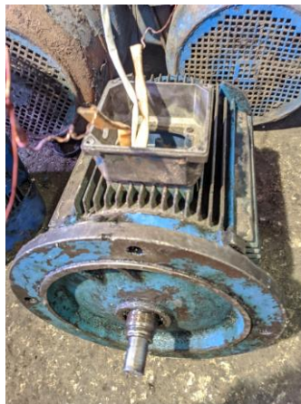
Gambar 2.22 Membongkar elmot 2,2 Kw untuk konveyor Sumber : Dokumentasi pribadi
