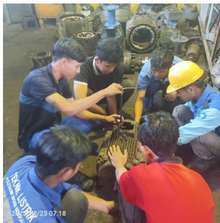
Gambar 2. 62 Membongkar elmot airlock Sumber : Dokumentasi pribadi
