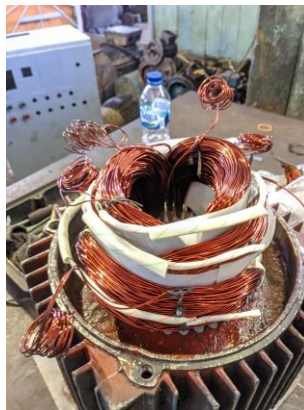
Gambar 2. 36 Memasang kertas prespan untuk elmot crane 7,5 Kw Sumber : Dokumentasi pribadi
