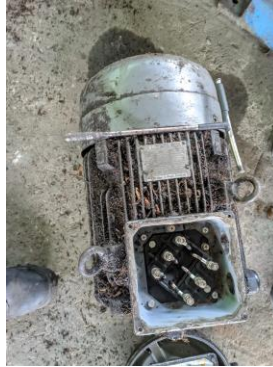
Gambar 2. 49 Mengganti bearing elmot vibershell Sumber : Dokumentasi pribadi
