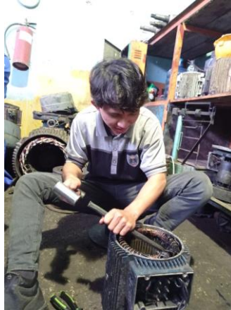
Gambar 2. 59 Membongkar elmot 7,5 Kw untuk vibershell Sumber : Dokumentasi pribadi
