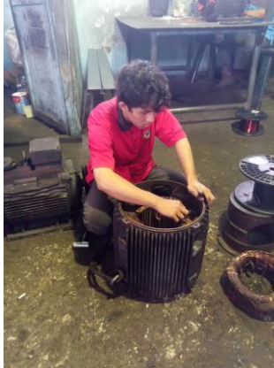
Gambar 2. 45 Membongkar elmot untuk waduk 37 Kw Sumber : Dokumentasi pribadi
