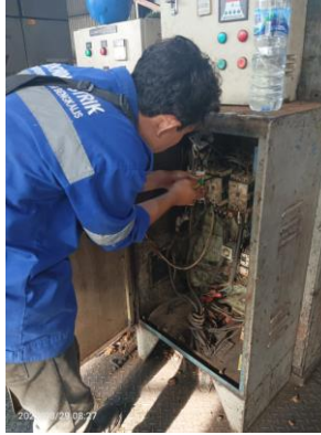
Gambar 2. 67 Membalikkan putaran untuk elmot pressan no 2 Sumber : Dokumentasi pribadi
