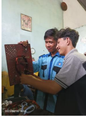
Gambar 2. 57 Melilit kawat email untuk elmot konveyor Sumber : Dokumentasi pribadi
