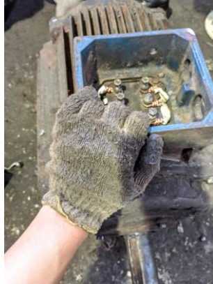
Gambar 2. 33 Merakit elmot untuk blower Sumber : Dokumentasi pribadi
