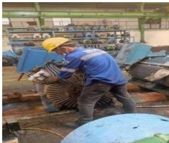
Gambar 2. 4 melepaskan kipas motor listrik
