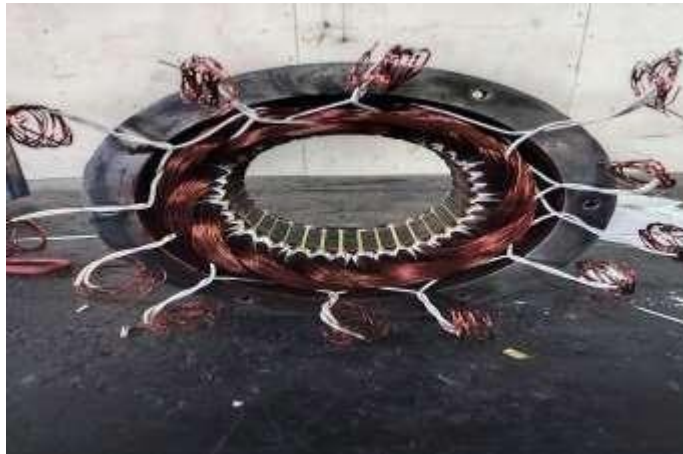
Gambar 4. 1 pemasangan coil baru pada motor listrik
