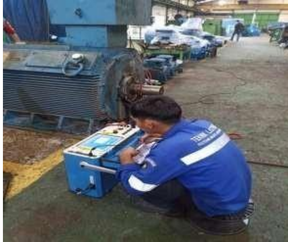
Gambar 2. 8 pengecekan kerusakn motor listrik
