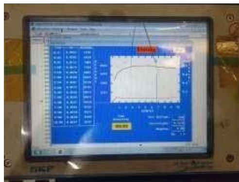
Gambar 3. 3 Tes isolasi resistansi
