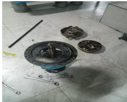
Gambar 2. 12Repair Pompa Centrifugal (sumber: dokumentasi pribadi)
