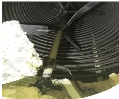
Gambar 2. 8 PM pada Agitator (sumber: dokumentasi pribadi)
