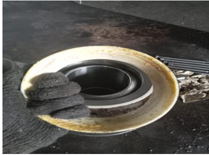
Gambar 4. 8 Seat rusak (Sumber: Dokumentasi Pribadi)
