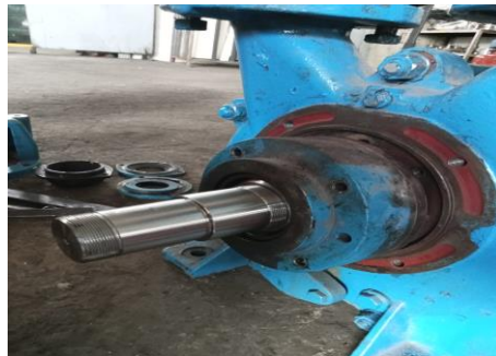
Gambar 2. 14 Repair Pompa Vakum (sumber: dokumentasi pribadi)
