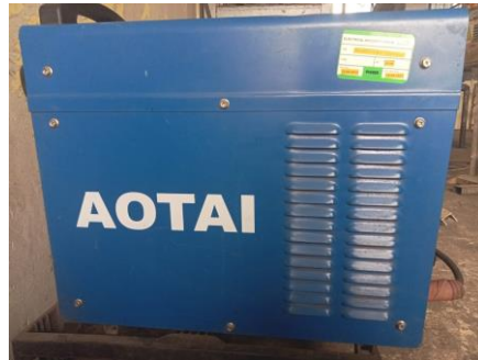
Gambar 2. 30 Trafo Las (sumber: dokumentasi pribadi)
