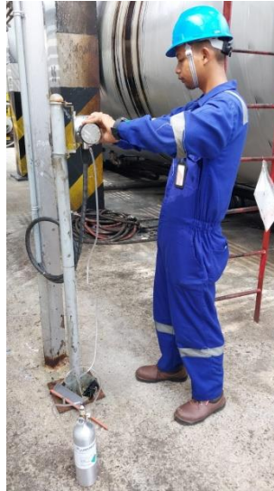
Gambar 3.10 Proses Kalibrasi GM S5000 Sumber : Dokumentasi, 2023
