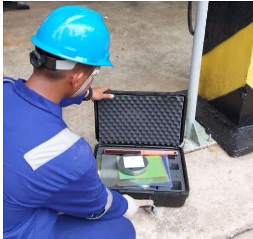
Gambar 3.9 Perlengkapan perawatan dan kalibrasi GM S5000 Sumber : Dokumentasi, 2023
