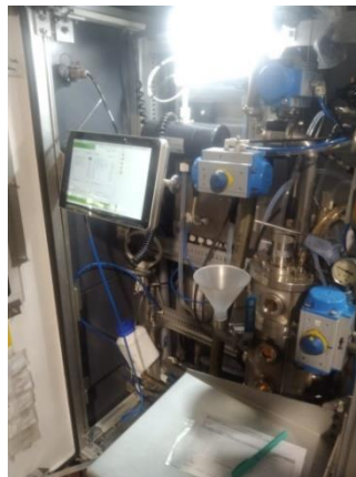
Gambar 2. 36 Pengenalan Sensor Kappa di FL8 (Sumber : Dokumentasi PT. Indah Kiat pulp & paper Tbk Perawang, 2023)
