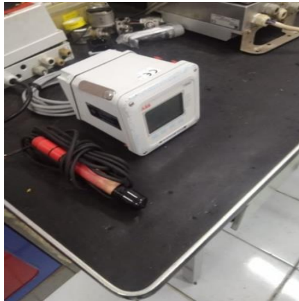
Gambar 2. 33 Pengenalan Sensor PH Meter Di Workshop (Sumber : Dokumentasi PT. Indah Kiat pulp & paper Tbk Perawang, 2023)
