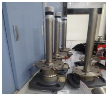
Gambar 2. 14 Sensor Brightness (Sumber : Dokumentasi PT. Indah Kiat pulp & paper Tbk Perawang, 2023)
