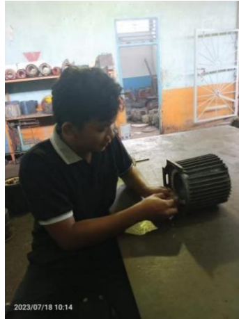
gambar 2. 3 4 Pemasangan kertas presspan
