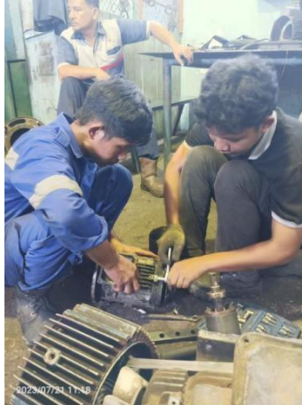
gambar 2. 3 6 Pembongkaran elmot (Sumber: PTPN V SEI BUATAN )
