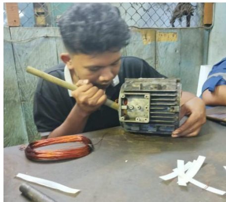
gambar 2. 4 0 Pemasangan lilitan elmot (Sumber: PTPN V SEI BUATAN )
