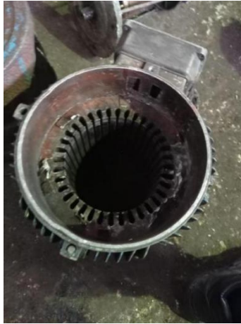
gambar 2.1 8 Pembongkaran elmot (Sumber: PTPN V SEI BUATAN )
