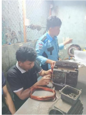
gambar 2.2 4 Pemasangan lilitan elmot (Sumber: PTPN V SEI BUATAN )
