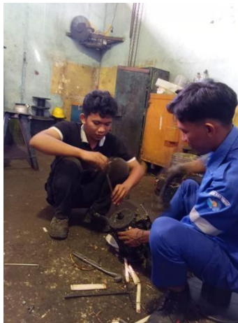
gambar 2. 3 8 Pembongkaran elmot (Sumber: PTPN V SEI BUATAN )
