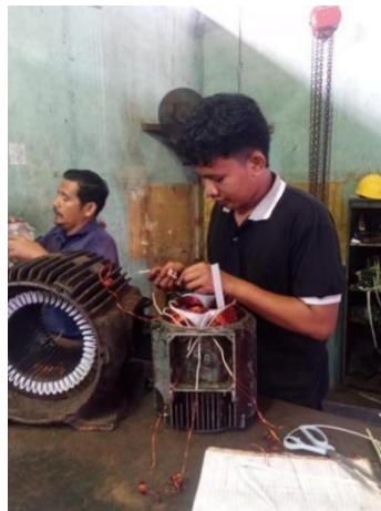
gambar 2.2 5 Pemasangan lilitan (Sumber: PTPN V SEI BUATAN )
