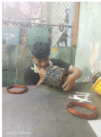
gambar 2. 4 2 Pemasangan lilitan elmot (Sumber: PTPN V SEI BUATAN )
