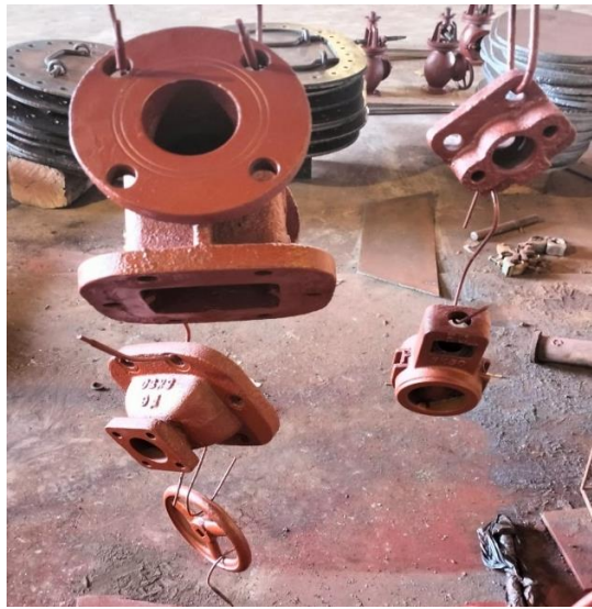
Gambar 3.2 : service dan pengecatan gate valve Sumber : dokumentasi sendiri
