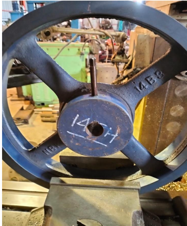
Gambar 3.1 : Proses pembuatan ulir untuk pully mesin rolling Sumber : dokumentasi sendiri
