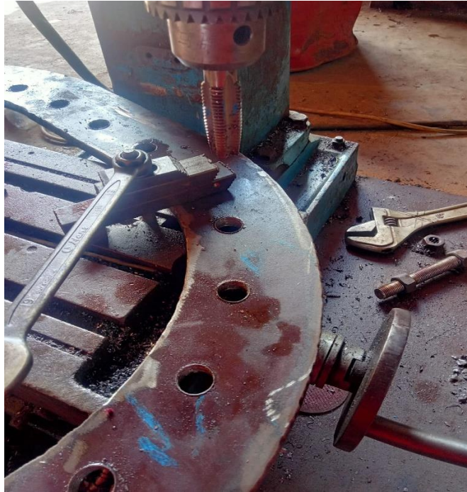
Gambar 4.6 proses pengetapan Base manhole Sumber : Dokumentasi sendiri
