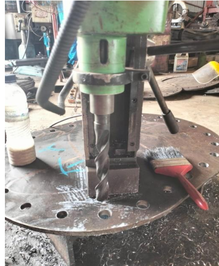
Gambar 4.5 proses pengeboran Base dan cover manhole Sumber : Dokumentasi sendiri
