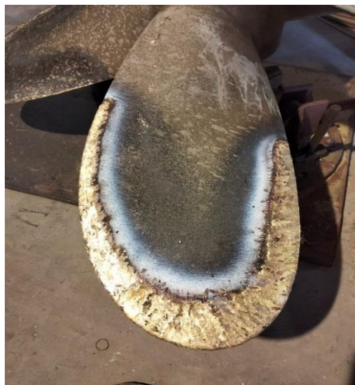
Gambar 3.3 : perawatan dan service propeller Sumber : dokumentasi sendiri
