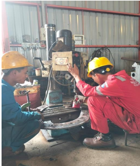
Gambar 4.5 proses pengeboran Base dan cover manhole Sumber : Dokumentasi sendiri
