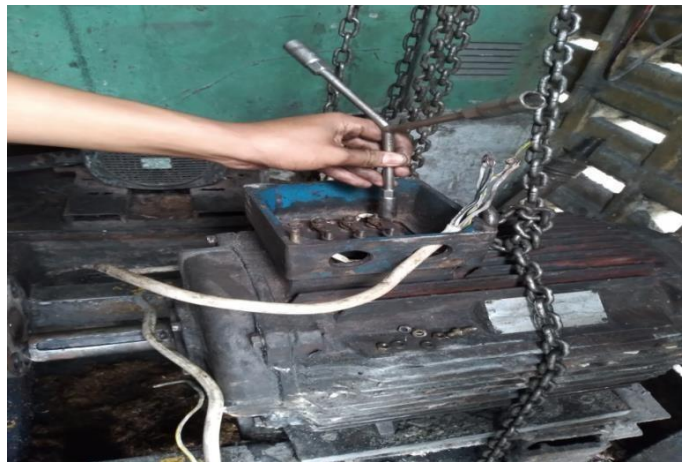
Gambar 2. 61 Mengganti Elmot Yang Terbakar (Sumber: Dokumentasi di PTPN V SEI BUATAN )
