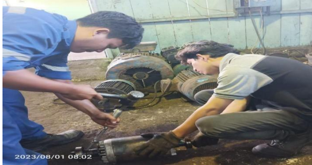
Gambar 2. 45 Melepaskan Bering Pada Elmot (Sumber: Dokumentasi di PTPN V SEI BUATAN )
