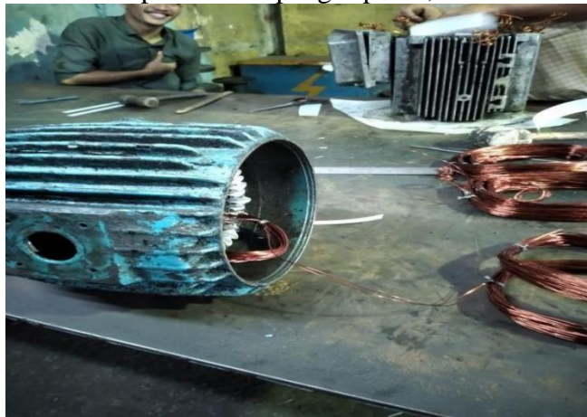
Gambar 2. 58 Menggulung Lilitan Pada Elmot (Sumber: Dokumentasi di PTPN V SEI BUATAN )
