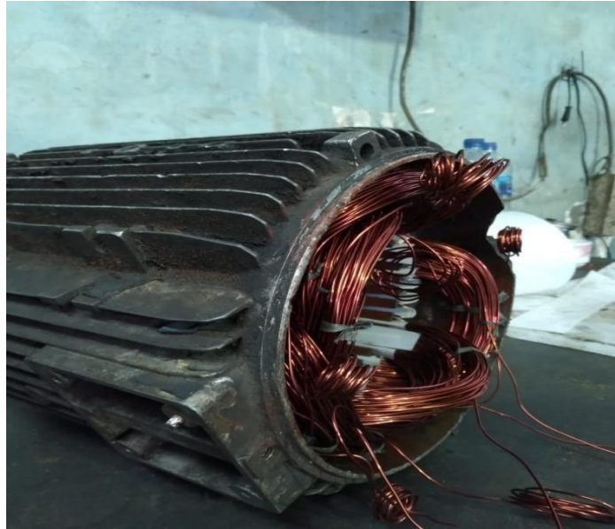
Gambar 2. 55 Menggulung Lilitan Pada Elmot (Sumber: Dokumentasi di PTPN V SEI BUATAN )
