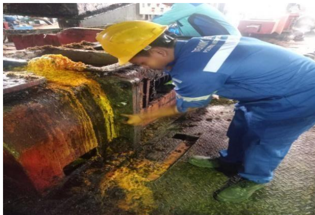
Gambar 2. 13 Memperbaiki Gear Bok Pada Mesin Presan
