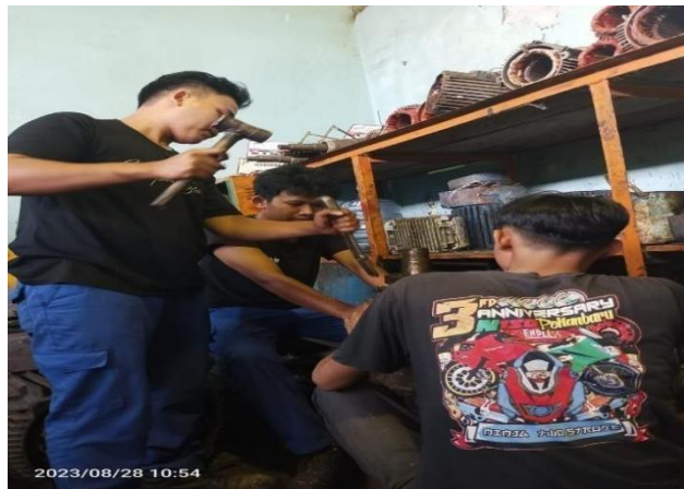
Gambar 2. 68 Memasang Bering Pada Rotor (Sumber: Dokumentasi di PTPN V SEI BUATAN )
