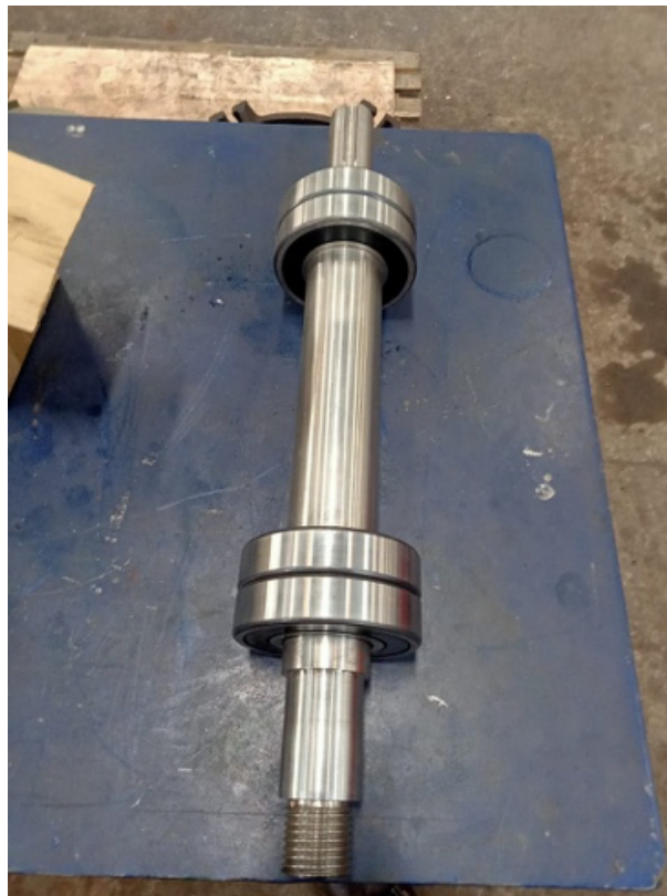
Gambar 4. 16 Pemasangan kedua buah Bearing (Sumber: dokumen pribadi)
