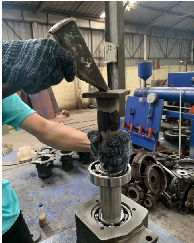
Gambar 4. 17 Pemasangan Drive Shaft
