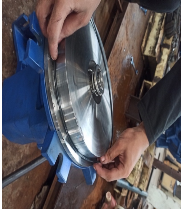
Gambar 4. 22 Pemasangan O-Ring (Sumber: dokumen pribadi)
