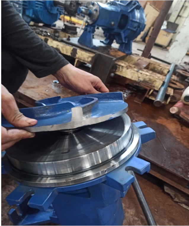
Gambar 4. 23 Proses Pemasangan Impeller
