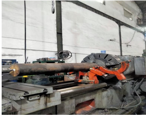
Gambar 4.4 bahan dinaikkan ke mesin bubut (Sumber: dokumen pribadi)
