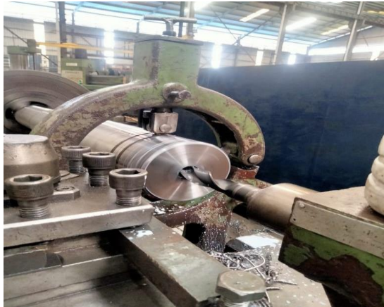
Gambar 4.13 proses pengeboran lubang center belakang (Sumber: dokumen pribadi)
