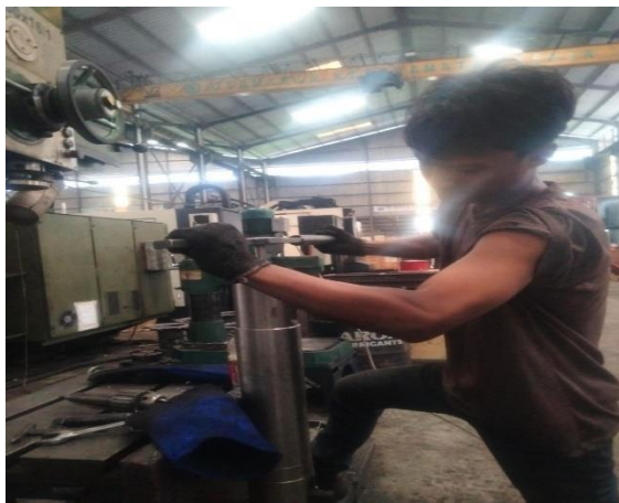
Gambar 4.12 proses pembuatan ulir menggunakan tap (Sumber: dokumen pribadi)
