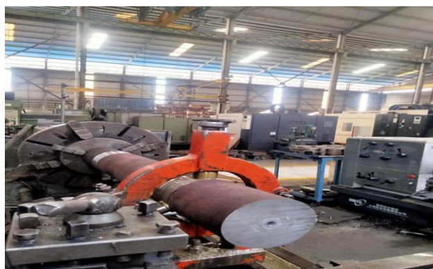
Gambar 4.5 bahan telah selesai trim dan pengeboran lubang center (Sumber: dokumen pribadi)
