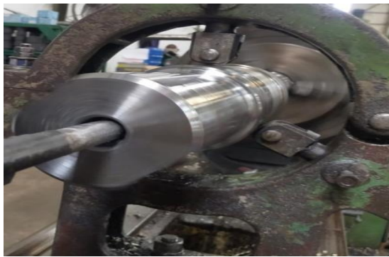
Gambar 4.14 proses pembuatan ulir pada lubang center belakang (Sumber: dokumen pribadi)
