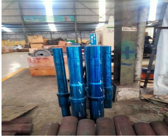
Gambar 4.15 pengecatan drive shaft (Sumber: dokumen pribadi)
