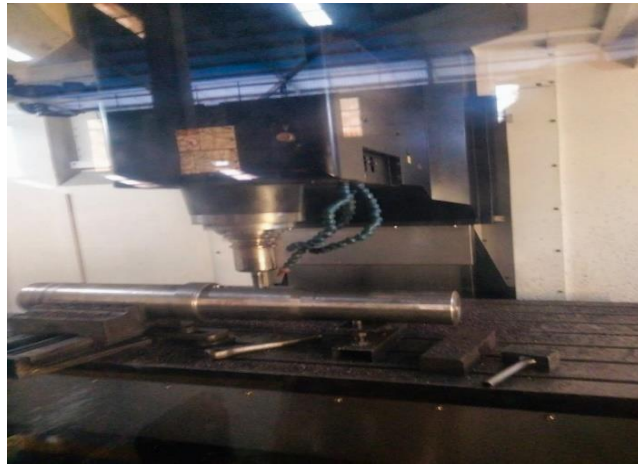
Gambar 4.10 proses pembuatan lubang spi menggunakan CNC milling (Sumber: dokumen pribadi)
