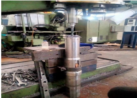
Gambar 4.11 proses pengeboran center depan menggunakan mesin bor radial (Sumber: dokumen pribadi)
