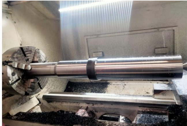
Gambar 4.7 drive shaft yang telah selesai pemakanan 75%
