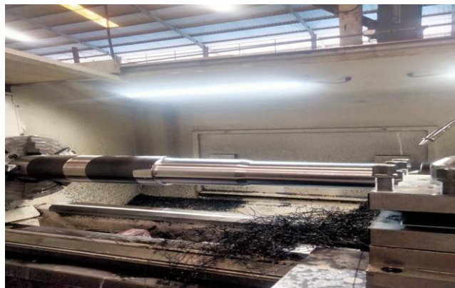
Gambar 4.6 drive shaft yang telah selesai pemakanan 50%
