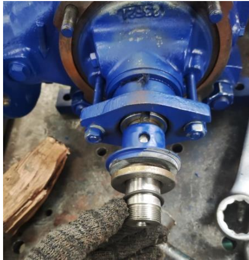
Gambar 4.27 Pemasangan Gland Box
