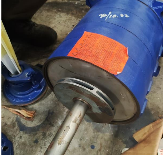
Gambar 4.21 Masukkan Impeler yang sudah ditrim
