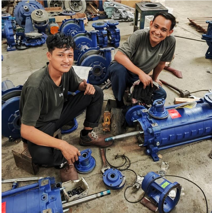
Gambar 1 Pembongkaran Pompa Multistage
