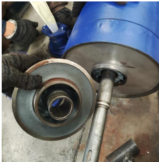
Gambar 4.22 Pemasangan Impeler ukuran standar
