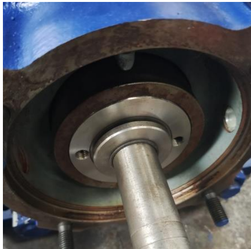
Gambar 4.26 Pemasangan Disc dan O-Ring
