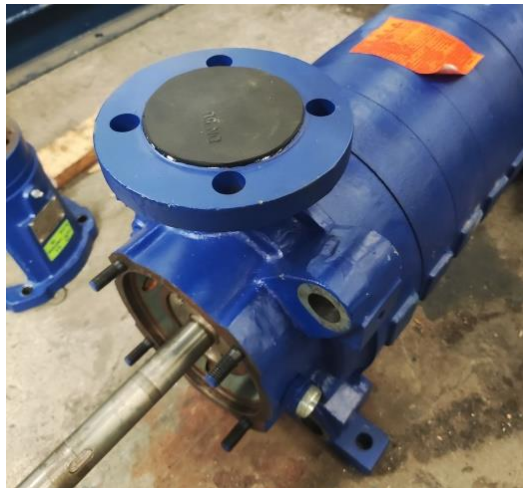
Gambar 4.24 Pemasangan Discharge Casing
