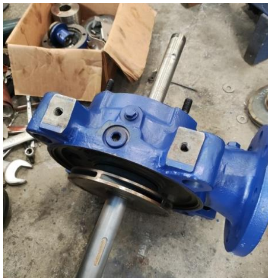
Gambar 4. 18 Memasukkan Shaft dan Impeler Section
