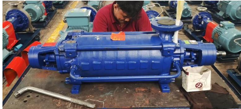
Gambar 4. 31 Pompa Multistage siap Test Hidrolic
