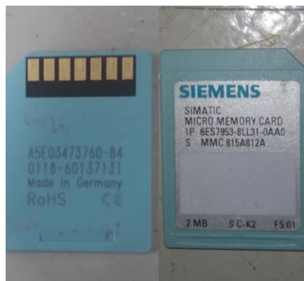
Gambar 3. 13 memori eksternal dari siemens (Sumber: Dokumentasi PT. Riau Andalan Pulp and Paper Pangkalan Kerinci, 2023)
