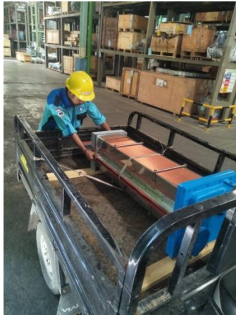
Gambar 2. 42 Mengambil intercooler untuk pendingin compressor di material
