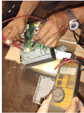
Gambar 2. 31 Mengecek permasalahan pada display compressor elgi di PG 2.
