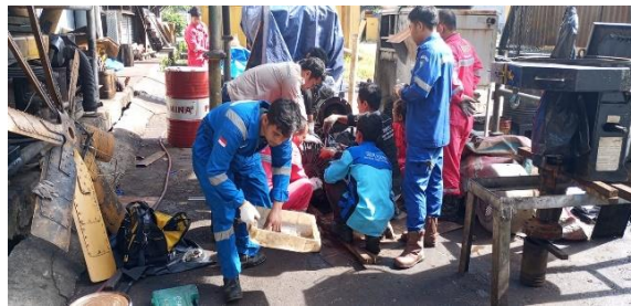
Gambar 4.2 Proses pembukaan komponen motor induksi (Dokumentasi pribadi 2023)
