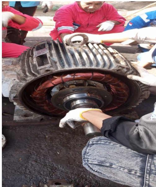
Gambar 4.5 main stator dan main rotor yang sudah di bersih (Dokumentasi pribadi 2023)
