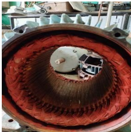
Gambar 4.3 Stator (Dokumentasi pribadi 2023)
