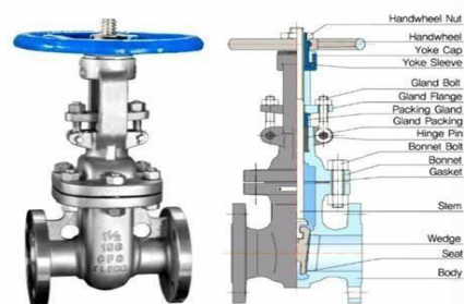
Gambar 4. 1 Bagian utama valve
