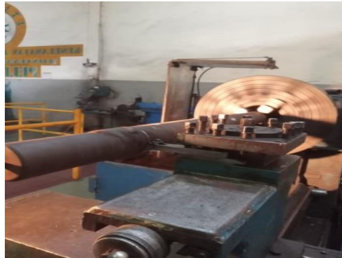
Gambar 4. 8 pembubutan pemanjang Sumber : Dokumentasi
