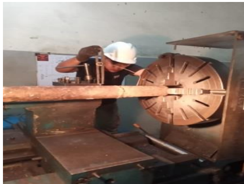
Gambar 4. 5 setting benda kerja Sumber : Dokumentasi
