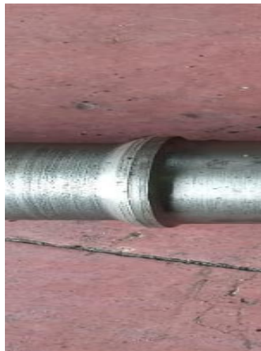
Gambar 4. 13 pembubutan poros bertingkat Sumber : Dokumentasi
