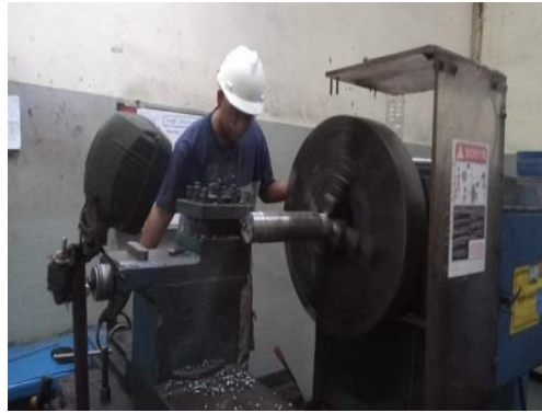
Gambar 4. 12 pembubutan poros bertingkat Sumber : Dokumentasi
