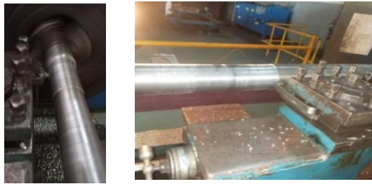
Gambar 4. 10 pembubutan bertingkat Sumber : Dokumentasi
