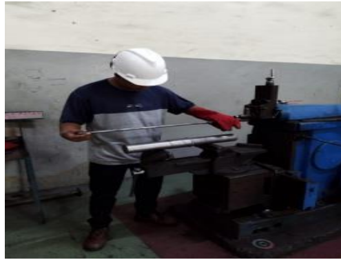
Gambar 4. 15 proses sekrap spie roda Sumber : Dokumentasi
