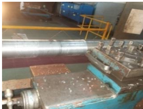
Gambar 4. 9 pembubutan bertingkat Sumber : Dokumentasi
