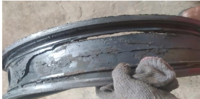
Gambar 4. 18 Rubber Rusak (sumber: dokumentasi pribadi)
