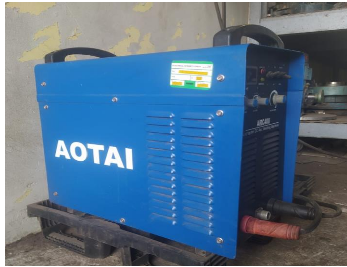
Gambar 3. 20 Trafo Las (sumber: dokumentasi pribadi)
