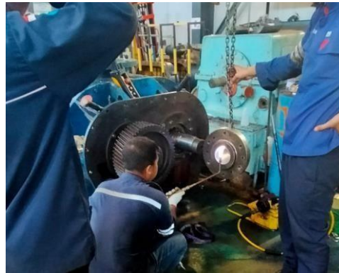
Gambar 4. 10 proses pemansan coupling Sumber. Dokumentasi pribadi
