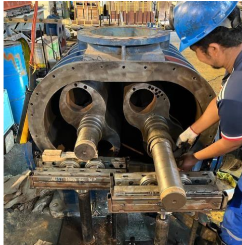
Gambar 4. 6 instal lobe drive dan driven to lower casing Sumber.dokumentasi pribadi
