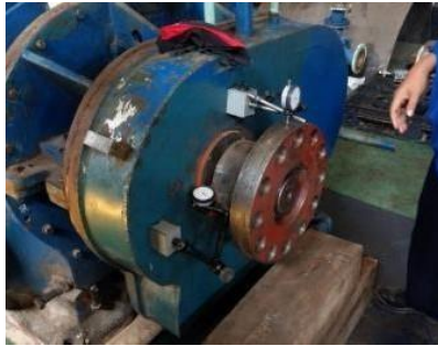
Gambar 4. 3 chek run out coupling Sumber.dokumentasi pribadi
