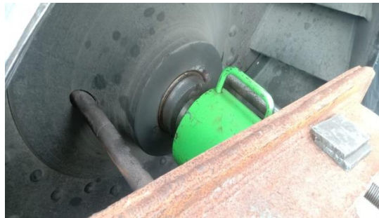
Gambar 4. 23 Pelepasan impeler dengan shaf
