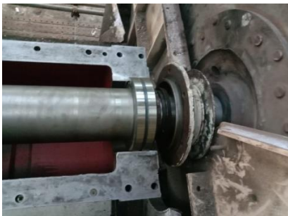
Gambar 4. 38 Penyetingan pada house bearing
