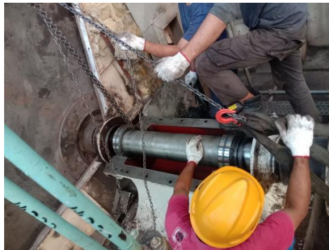
Gambar 4. 24 Pemindahan shaft dan impeler ke area bawah
