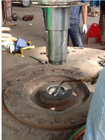
Gambar 4. 36 Proses pemasangan shaft dan impeller
