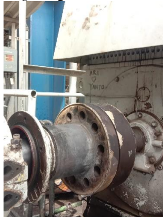
Gambar 4. 16 Pelepasan bout coupling
