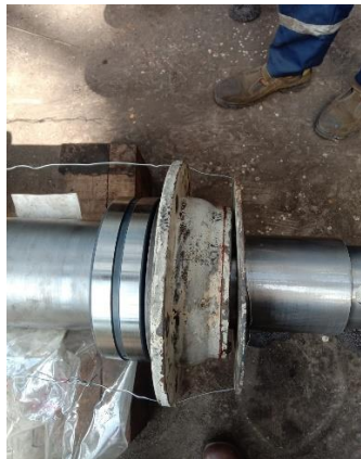
Gambar 4. 33 Pemasangan cover labirin ke shaft
