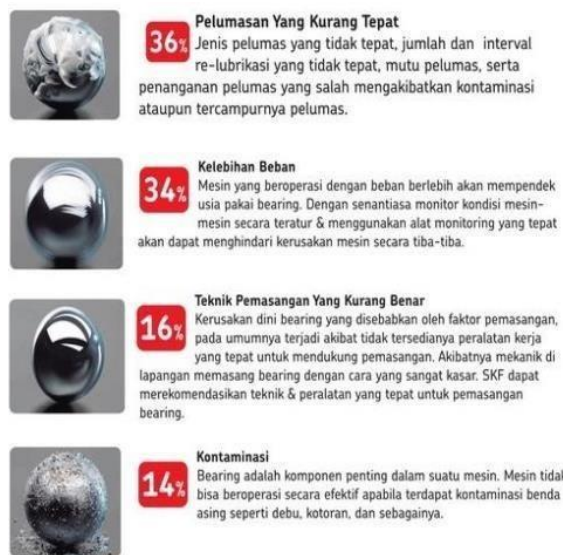
Gambar 4. 7 Penyebab Terjadinya Kerusakan Bearing
