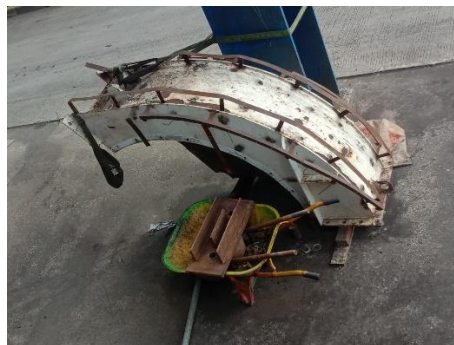
Gambar 4. 21 Pelepasan house impeler
