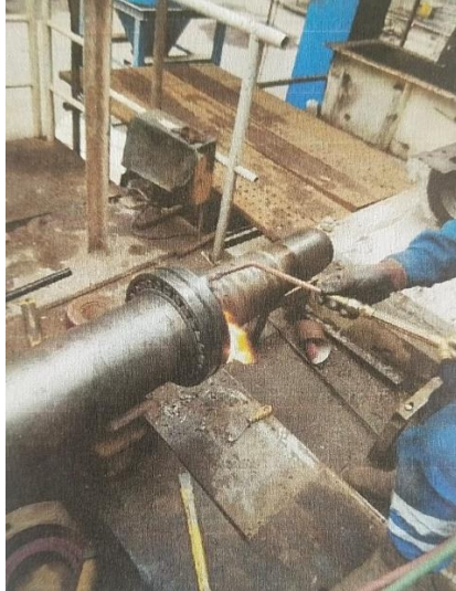
Gambar 4. 27 Pelepasan dua bearing shaft
