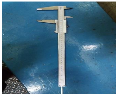
Gambar 3. 11 Jangka sorong Sumber: Dokumentasi
