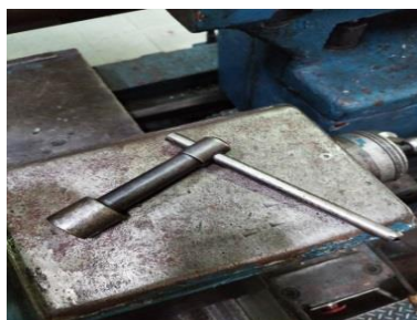
Gambar 3. 10 kunci Chisel holder Sumber: Dokumentasi
