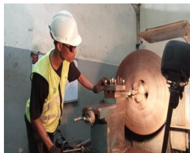
Gambar 4. 8 Pembubutan rata Sumber: Dokumentasi
