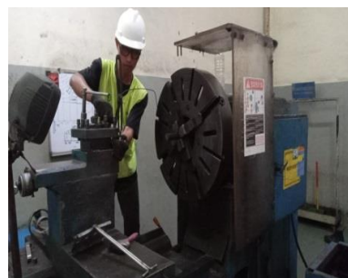
Gambar 4. 4 setting benda kerja Sumber: Dokumentasi
