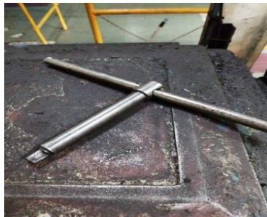
Gambar 3. 9 kunci chuck Sumber: Dokumentasi
