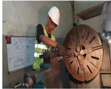
Gambar 4. 5 Pemasangan Mata Pahat Sumber: Dokumentasi
