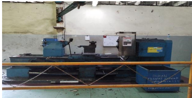
Gambar 4. 1 Mesin bubut Sumber: Dokumentasi
