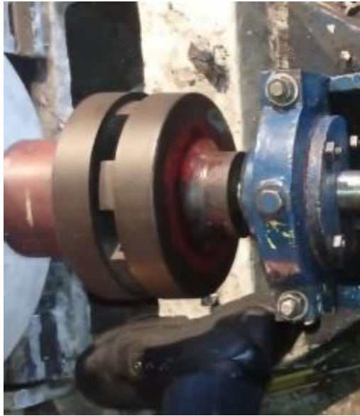
Gambar 4.21 Alignment pompa dengan motor (Sumber : Dokumentasi Sendiri )
