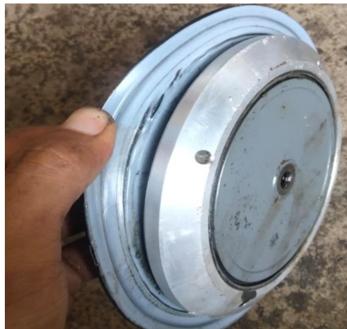
Gambar 3.11 Penggantian membran (Sumber : Dokumentasi Pribadi)
