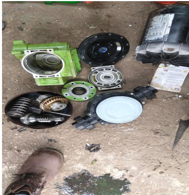
Gambar 4.1 pompa injeksi kimia (Sumber :dokumentasi pribadi)
