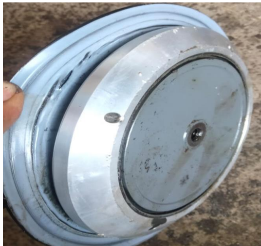
Gambar 4.13 kerusakan membran (dokumentasi probadi)
