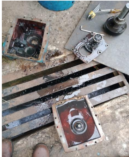
Gambar 2.4 Servis Gearbox Nut Greding (sumber : dokumentasi penulis 2023)
