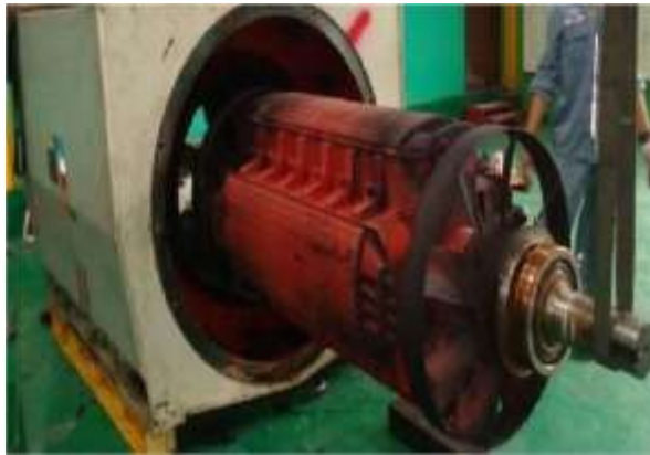
Gambar 3.7 Proses Pembongkaran Rotor
