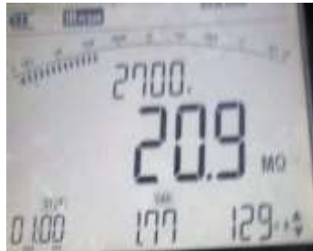
Gambar 3.13 Pengukuran Insulasi Selama 1 Menit
