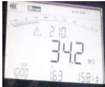
Gambar 3.14 Pengukuran Insulasi Selama 10 Menit
