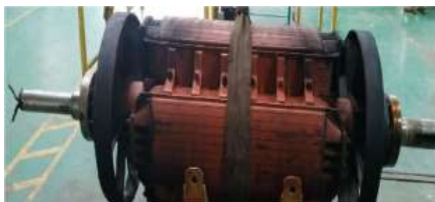
Gambar 3.8 Kondisi Main Rotor Sebelum Dibersihkan
