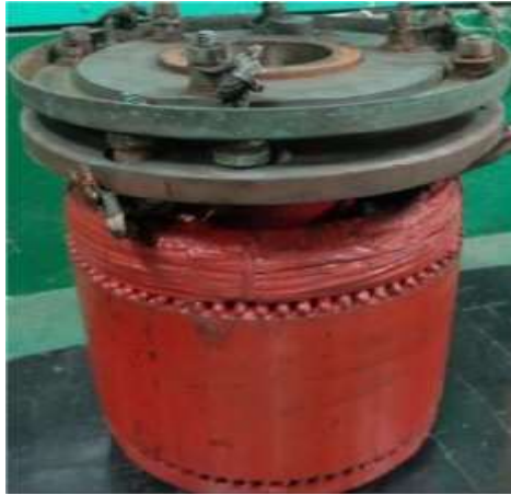
Gambar 3.10 Kondisi Rotor Exciter Sebelum Dibersihkan
