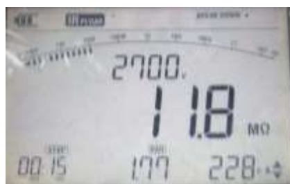
Gambar 3.12 Pengukuran Insulasi Selama 15 Detik
