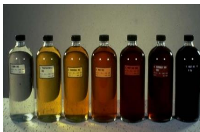
Gambar 3.1Warna minyak trafo (sumber: google. com)
