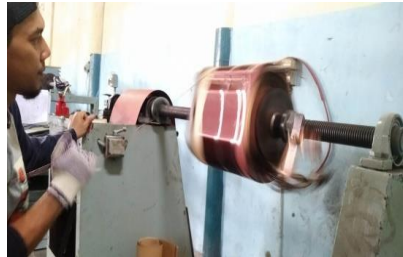
Gambar 2.41 Penggulangan kawat (Sumber : dokumentasi 2023)
