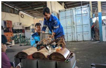
Gambar 2.43 Pemasangan kor (Sumber : dokumentasi 2023)
