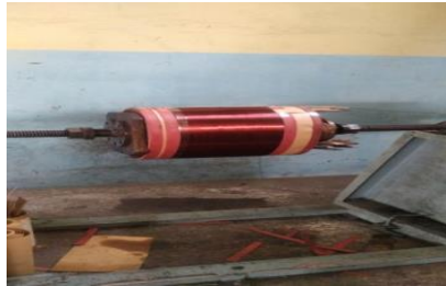
Gambar 2.17 Penggulungan kawat trafo (Sumber : dokumentasi 2023)
