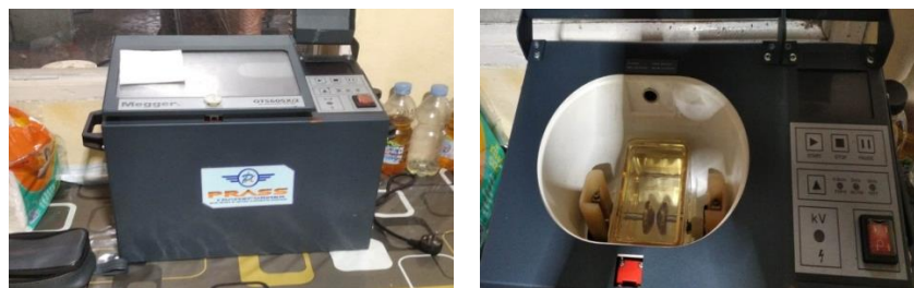
Gambar 4.9 Alat pengecekan tegangan tembus ( oil dielektrik tes ) (sumber : dokumentasi 2023)
