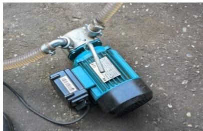
Gambar 2.75 Pompa minyak trafo (sumber : PT.PRASS)
