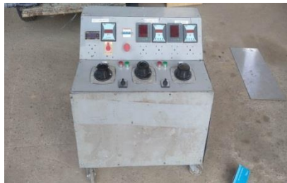
Gambar 2.10 Perbaikan alat penguji trafo (Sumber : dokumentasi 2023)
