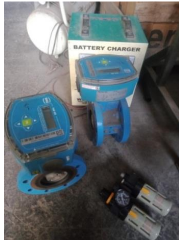
Gambar 2.68 Flowmeter Sumber: (Dokumentasi, 2023)
