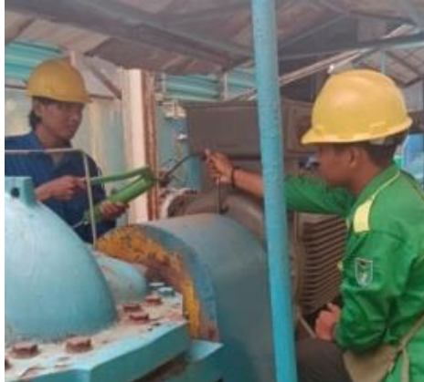
Gambar 2.48 Memberi Grease Motor di Refinery Sumber: (Dokumentasi, 2023)
