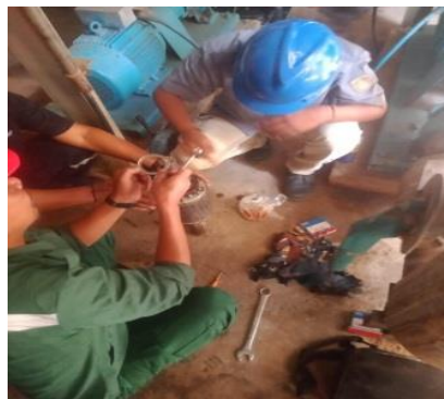
Gambar 2.9 Bongkar dan Ganti Bearing Motor Sumber: (Dokumentasi, 2023)
