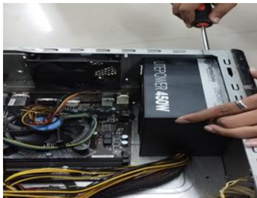
Gambar 4.12 Pemasangan Power Supply
