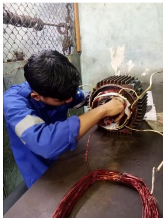
Gambar 2. 45 memasang lilitan kumparan pada elmots 7,5
