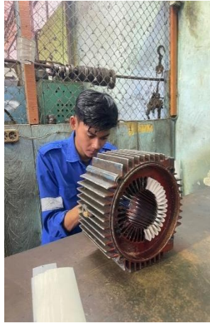
Gambar 2. 21 pemasangan pelastik prespan
