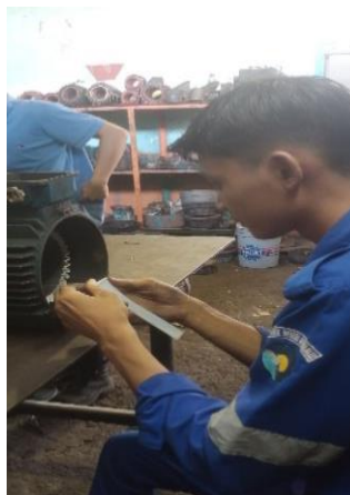
Gambar 2. 41 Pemasangan pelastik prespan pada elmots 7,5 kw
