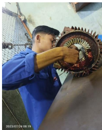
Gambar 2. 39 Memasang lilitan pada elmot 7,5 kw
