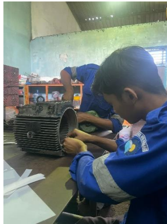
Gambar 2. 56 memasang pelastik prespan pada elmots7,5 kw
