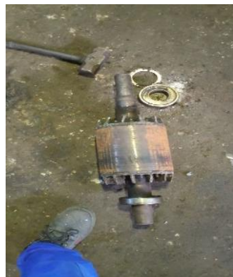
Gambar 2. 28 Mengganti bering pada elmots 22 kw
