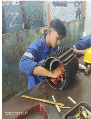
Gambar 2. 42 Pemasangan lilitan kumparan elmots 7,5 kw
