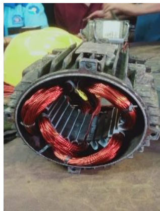
Gambar 2. 4 Pemasangan lilitan kumparan pada elmots 7,5kw
