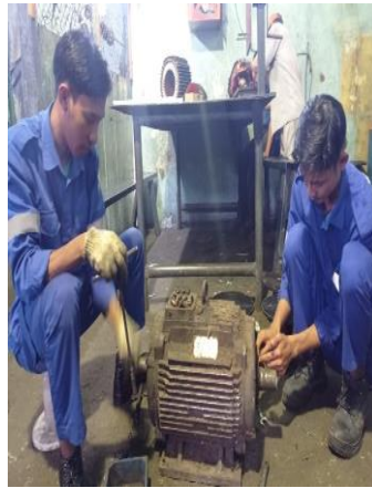
Gambar 2. 29 Mencopel elmots 15 kw deengan rpm 3000
