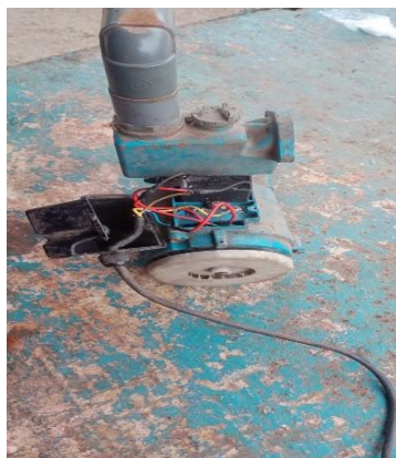
Gambar 2. 35 Memperbaiki elmots pompa 1,5 kw
