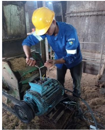
Gambar 2. 36 Memperbaiki elmots pada stasiun biji
