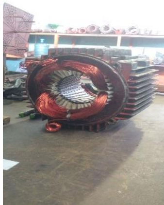
Gambar 2. 30 Memasang lilitan kawat tembaga pada elmots 7,5 kw
