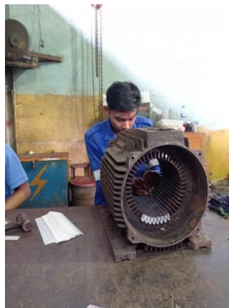
Gambar 2. 18 pemasangan pelastik prespan
