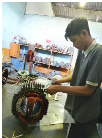
Gambar 2. 55 memasang lilitan kawat tembaga pada elmots 7,5 kw
