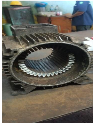
Gambar 2. 23 memasang pelastik prespan
