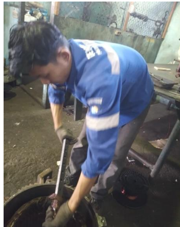
Gambar 2. 60 pembongkaran lilitan tembaga pada elmots
