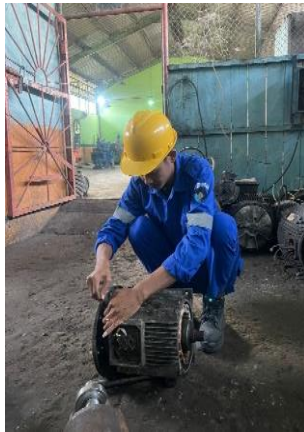
Gambar 2. 13 Mencopel elmots 7,5 kw
