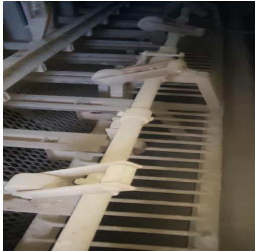
Gambar 3.10 Hammering Device (Sumber : Dokumentasi PT Sari Dumai Sejati)
