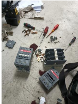
Gambar 2.21 Perbaikan Kontaktor Pada Modul Stater
