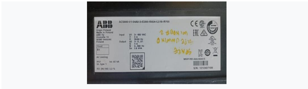
Gambar 3.2 Spesifikasi Drive Pada Drive ABB ACS- 880
