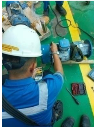
Gambar 2.8 Pengetesan dan Pengecekan Motor 3 phasa
