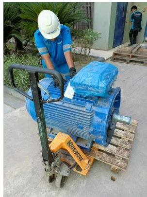
Gambar 2.47 Pemindahan Motor Hydraulic 110 Kw
