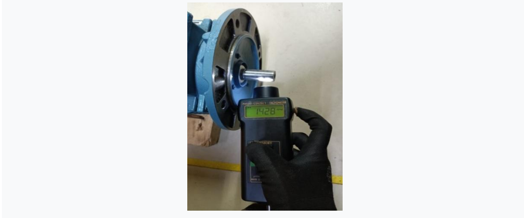
Gambar 4.18 Mengukur Rpm Dengan Set Point 100%
