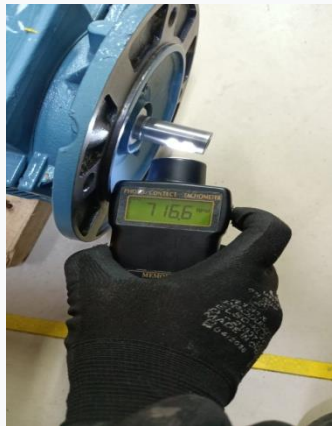
Gambar 4.16 Mengukur Rpm Dengan Set Point 50%
