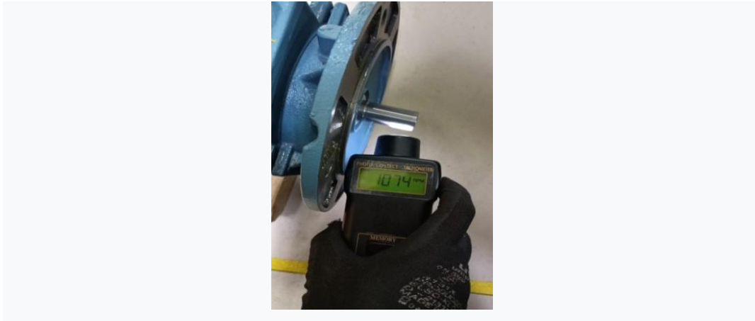
Gambar 4.17 Mengukur Rpm Dengan Set Point 75%
