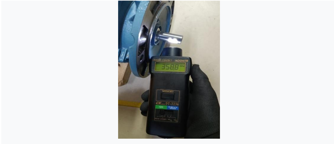
Gambar 4.15 Mengukur Rpm Dengan Set Point 25%
