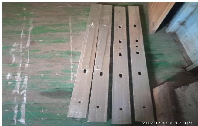
Gambar 3. 8 Travers / Cross Arm (Sumber: Dokumentasi Pribadi 2023)
