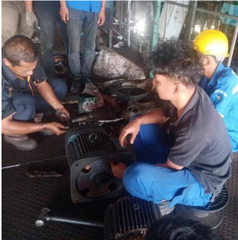
Gambar 2. 43 Memasang Motor Induksi (Sumber: Dokumentasi di PT. Perkebunan Nusantara V)
