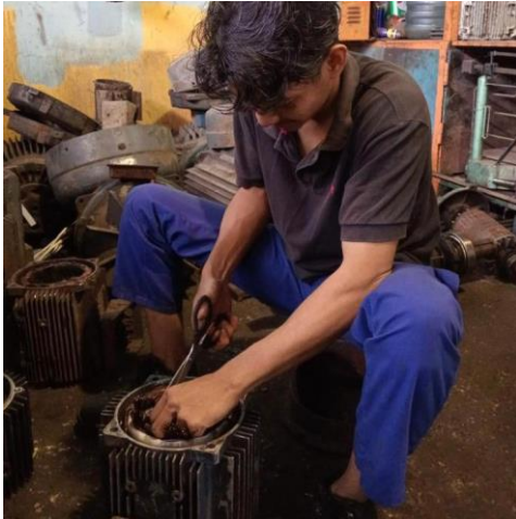
Gambar 2. 67 Membongkar Motor Induksi 3 Phasa (Sumber: Dokumentasi di PT. Perkebunan Nusantara V)
