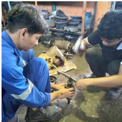
Gambar 2. 10 Mengganti Bearing Rotor (Sumber: Dokumentasi di PT. Perkebunan Nusantara V)
