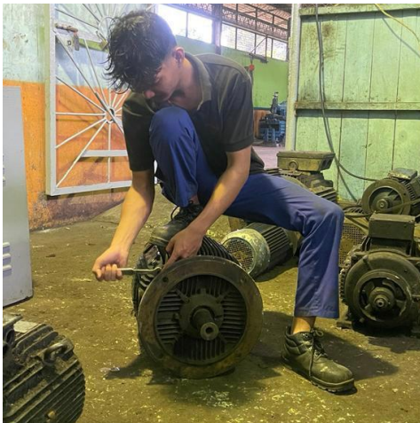
Gambar 2. 46 Membongkar Motor Induksi (Sumber: Dokumentasi di PT. Perkebunan Nusantara V)
