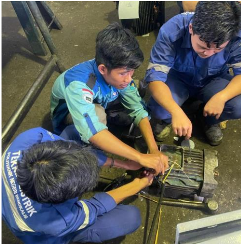
Gambar 2. 41 Merakit Motor Induksi (Sumber: Dokumentasi di PT. Perkebunan Nusantara V)
