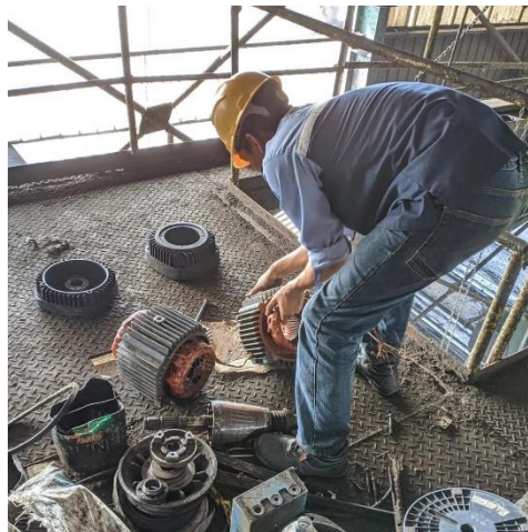
Gambar 2. 16 Mengganti Motor Induksi 3 Phasa (Sumber: Dokumentasi di PT. Perkebunan Nusantara V)
