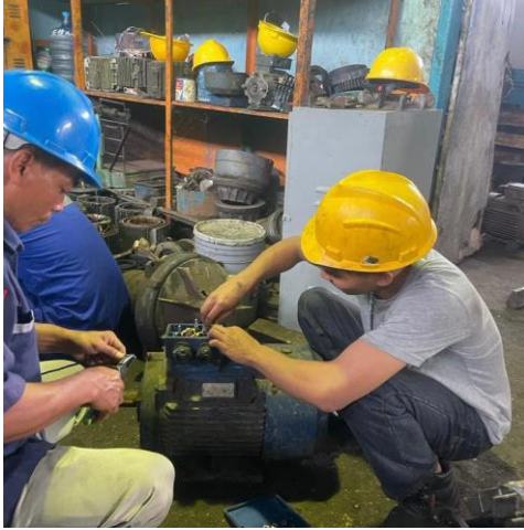
Gambar 2. 55 Mengetes Motor Induksi (Sumber: Dokumentasi di PT. Perkebunan Nusantara V)
