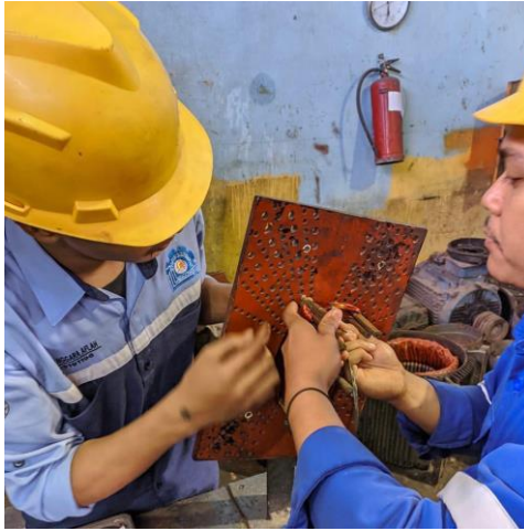
Gambar 2. 5 Menggulung Lilitan Tembaga (Sumber: Dokumentasi di PT. Perkebunan Nusantara V)
