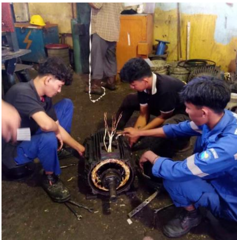
Gambar 2. 44 Merakit Motor Induksi (Sumber: Dokumentasi di PT. Perkebunan Nusantara V)
