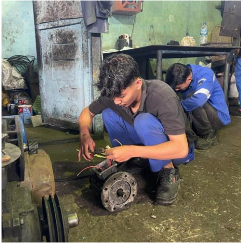
Gambar 2. 47 Mengetes Motor Induksi (Sumber: Dokumentasi di PT. Perkebunan Nusantara V)
