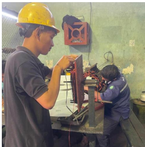
Gambar 2. 24 Menggulung Lilitan Tembaga (Sumber: Dokumentasi di PT. Perkebunan Nusantara V)
