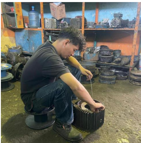
Gambar 2. 36 Membongkar Motor Induksi (Sumber: Dokumentasi di PT. Perkebunan Nusantara V)
