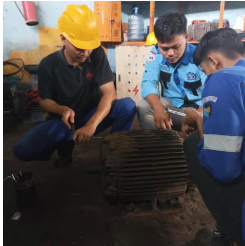
Gambar 2. 23 Membongkar Motor induksi 3 phasa (Sumber: Dokumentasi di PT. Perkebunan Nusantara V)
