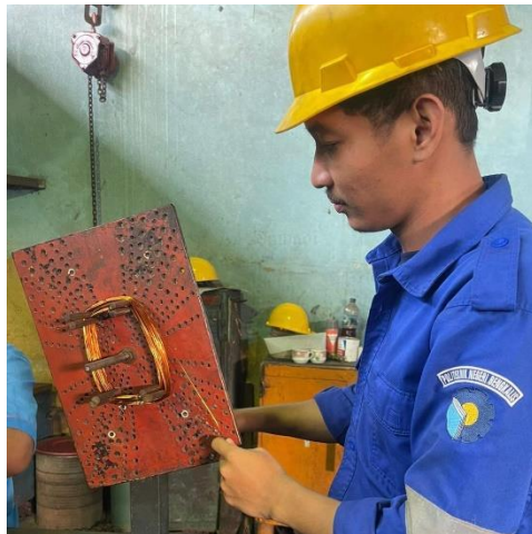
Gambar 2. 14 Menggulung Lilitan Tembaga (Sumber: Dokumentasi di PT. Perkebunan Nusantara V)
