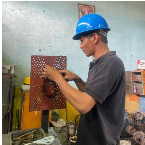
Gambar 2. 20 Menggulung Lilitan Tembaga (Sumber: Dokumentasi di PT. Perkebunan Nusantara V)
