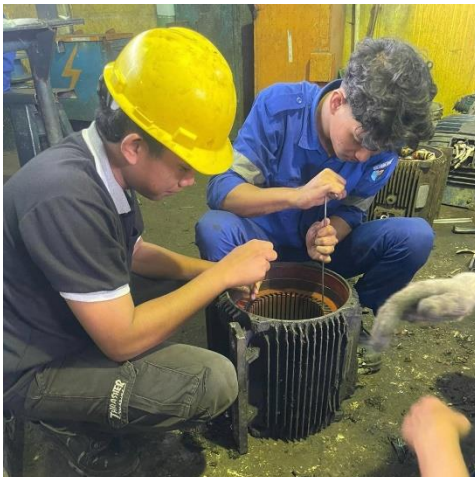
Gambar 2. 34 Membongkar Motor Induksi (Sumber: Dokumentasi di PT. Perkebunan Nusantara V)
