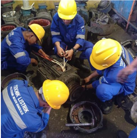
Gambar 2. 1 Mengetes Motor Induksi 3 Phasa (Sumber: Dokumentasi di PT. Perkebunan Nusantara V)
