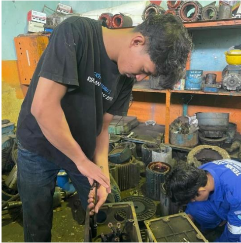
Gambar 2. 53 Membongkar Motor Induksi (Sumber: Dokumentasi di PT. Perkebunan Nusantara V)
