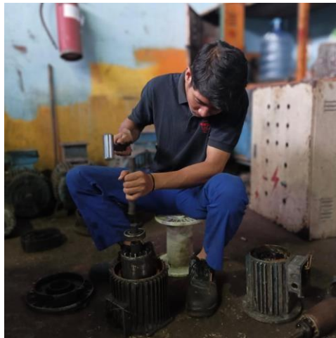
Gambar 2. 18 Mengganti Bearing (Sumber: Dokumentasi di PT. Perkebunan Nusantara V)
