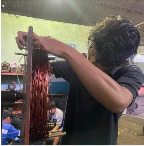
Gambar 2. 63 Menggulung Lilitan Tembaga (Sumber: Dokumentasi di PT. Perkebunan Nusantara V)
