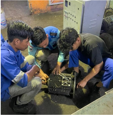
Gambar 2. 59 Merakit Motor Induksi (Sumber: Dokumentasi di PT. Perkebunan Nusantara V)
