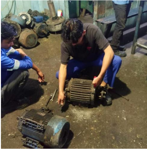
Gambar 2. 61 Membongkar Motor Induksi (Sumber: Dokumentasi di PT. Perkebunan Nusantara V)
