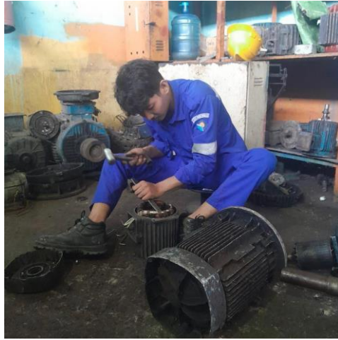
Gambar 2. 13 Membongkar motor induksi 3 phasa (Sumber: Dokumentasi di PT. Perkebunan Nusantara V)
