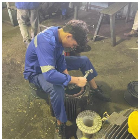
Gambar 2. 28 Membongkar Motor Induksi 3 Phasa (Sumber: Dokumentasi di PT. Perkebunan Nusantara V)
