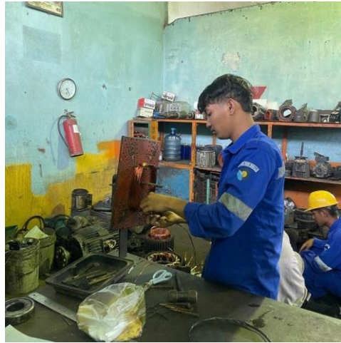
Gambar 2. 27 Menggulung Lilitan Tembaga (Sumber: Dokumentasi di PT. Perkebunan Nusantara V)
