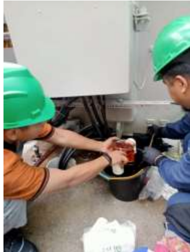
Gambar 2.34 Pengambilan sample oli generator
