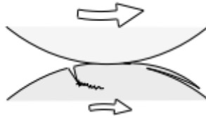
Gambar 4.7 Mekanisme Keausan fatik
