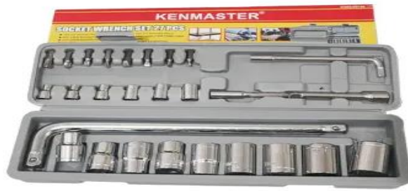
Gambar 3.7 Kunci shock atau kunci shoket (Sumber: Dokumentasi pribadi)
