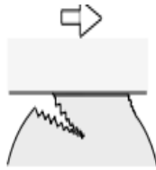
Gambar 4.5 Mekanisme Keausan adhesif
