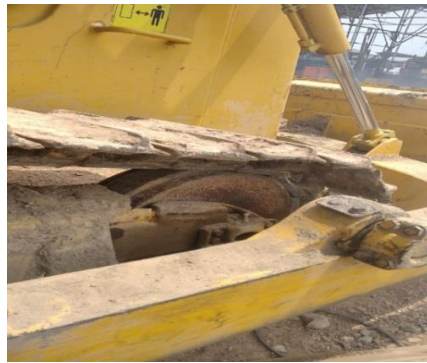
Gambar 4.19 Lepas baut pada tarck shoe dan track line (Sumber: PT. Vadhana International)
